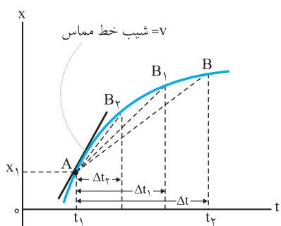
سرعت متوسط بین هر دو لحظه دلخواه، برابر شیب پاره‌خطی است که نمودار مکان - زمان را در آن دو لحظه به هم وصل می‌کند. همان‌طور که در شکل رو به رو دیده می‌شود اگر به تدریج کوچک و کوچک‌تر شود، نقطه A به نقطه B نزدیک و نزدیک‌تر می‌شود. با کوچک شدن تدریجی  $\Delta t$ ، نقطه A نزدیک می‌شود. در این صورت پاره‌خط واصل بین این دو نقطه، در حالتی که بازه زمانی  $\Delta t$  خیلی خیلی کوچک شود، به خط مماس بر نمودار نقطه A میل می‌کند.
